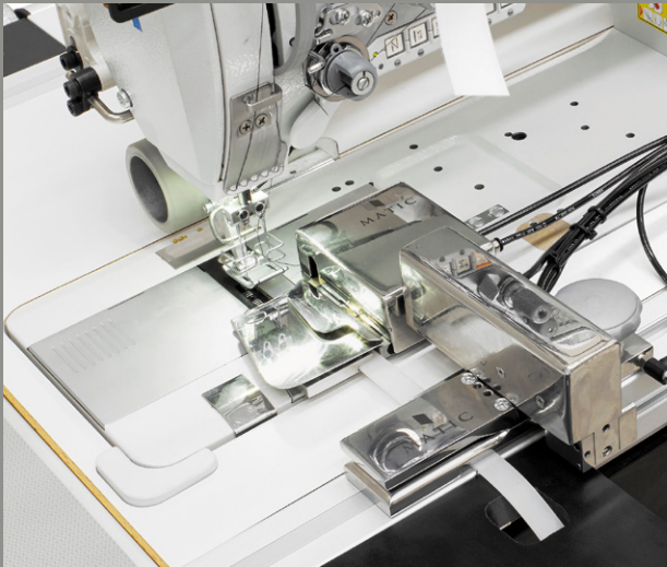
Automatic tape cutting and feeding system / Sistema automático de alimentación y corte de la cinta
