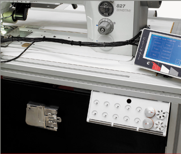
Storage for bobbins and guides / Almacén para canillas y guías
