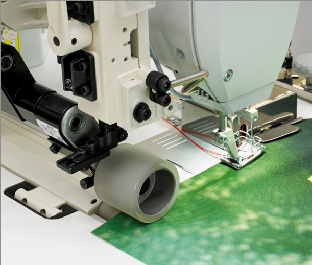
Puller device for heavy fabric / Dispositivo para materiales pesados
