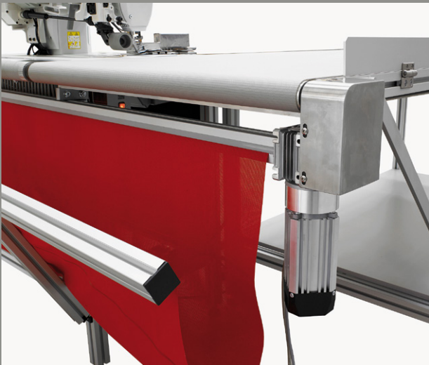
Fabric box in front of the machine / Bolsa de recogida en la parte delantera de la máquina
